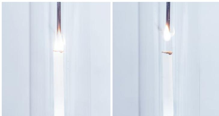
LOI Prüfung eines mit Flammenschutz ausgerüsteten Kunststoffs (oben) und eines nicht ausgerüsteten Kunststoffs (unten) während der Beflammung und nach Entfernen des Brenners.
